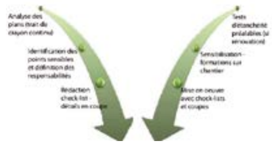
Principe de la démarche « Construire étanche à l'air » de la FFB Rhône-Alpes
